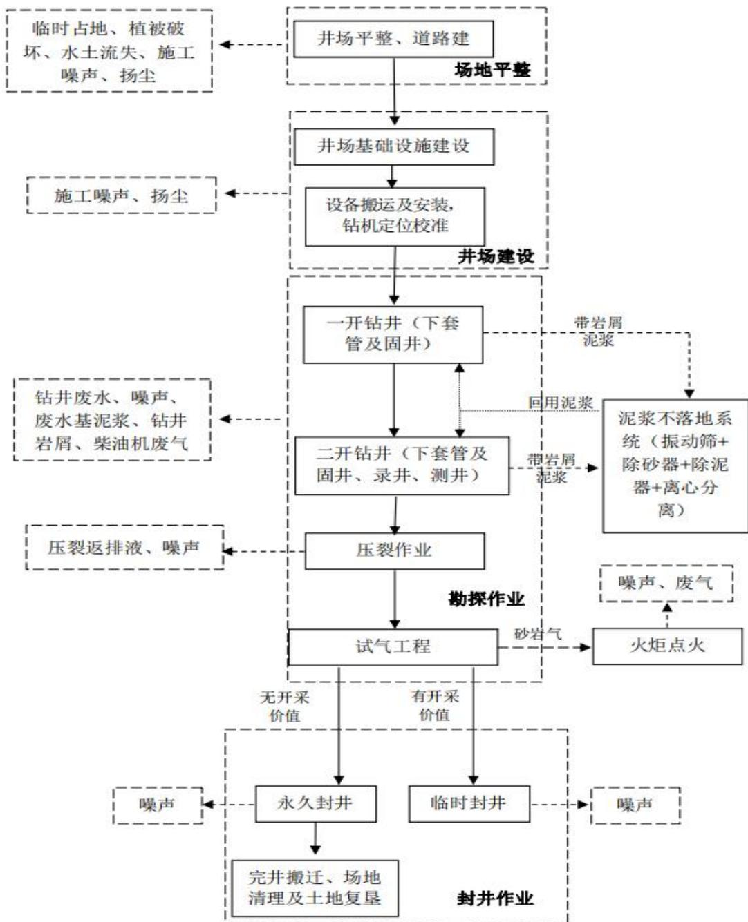
**图2-5 项目主要工艺流程及产污环节**
