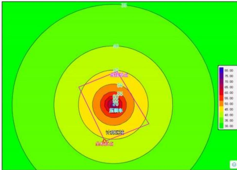
图 4-1 压裂期间噪声等声线图
