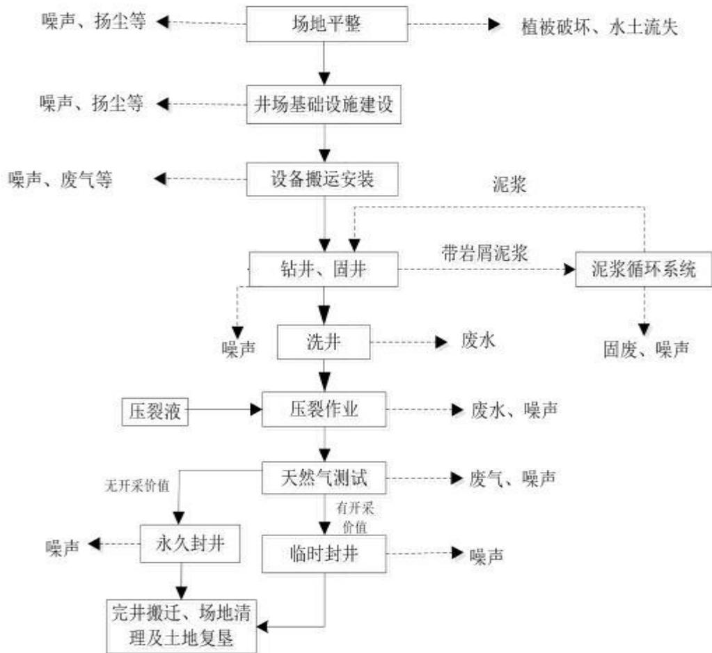
图2-1 项目主要工艺流程及产污环节图
