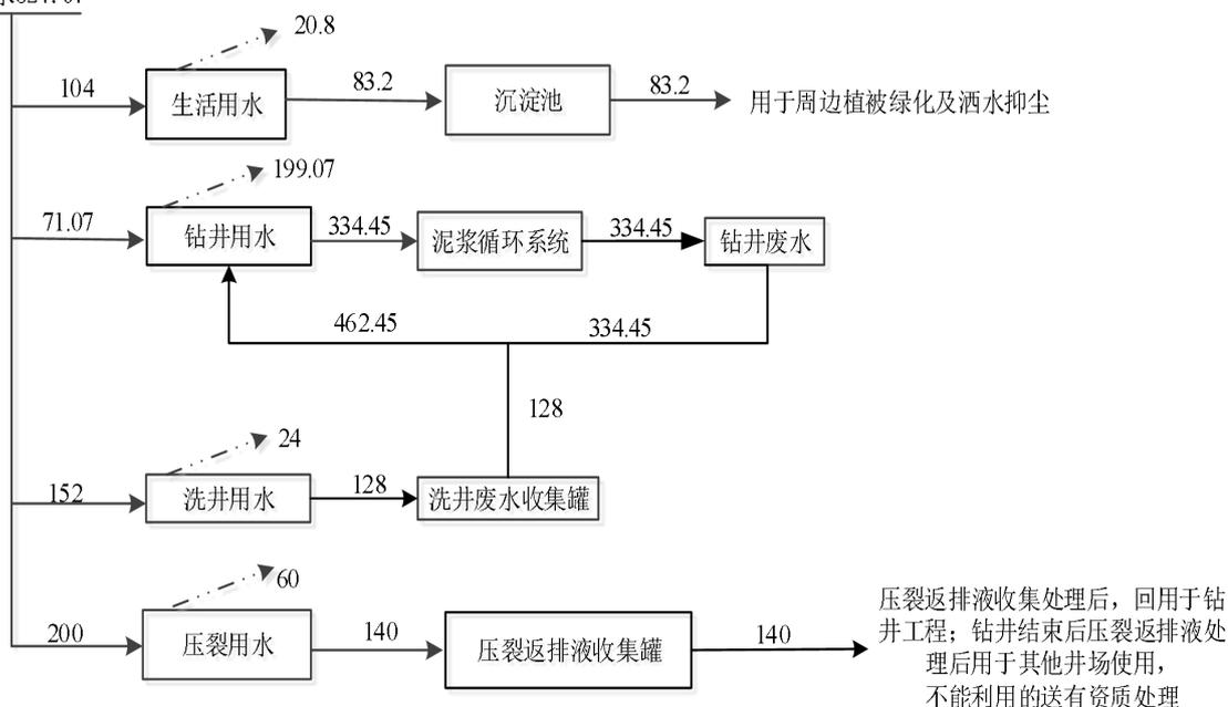
图2-1 项目水平衡图 单位m<sup>3</sup>
